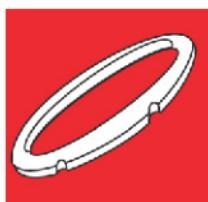
Após um longo período de uso, o Anel de Vedação poderá tornar-se dura ou o seu diâmetro poderá diminuir (encolher), perdendo assim o seu poder de vedação. Recomendamos esticá-la levemente, forçando a abertura de suas abas com o polegar e testá-la. Caso não vede, troque por outra nova e original.
