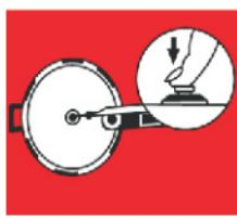
**VÁLVULA DE SEGURANÇA** - Abre caso ocorra excesso de pressão. Na válvula de silicone empurrar o plugue vermelho conforme a figura. Nunca improvise o fechamento dos furos.
